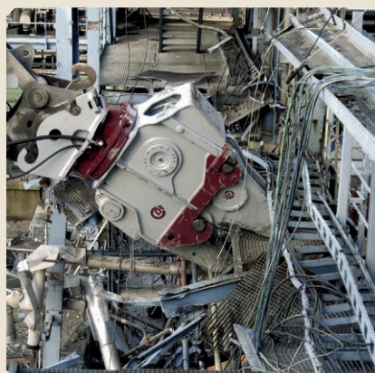
Dank auswechselbarer Schneidbacken ein universeller Zerkleinerer: Der MQP Multi-Quick Prozessor – hier mit Stahl-Backen
