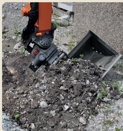
Der NOX Tiltrotator bewirkt als ein zylinderloses Universalgelenk mit 360° Endlosrotation höchste Effizienz auf jeder Baustelle
