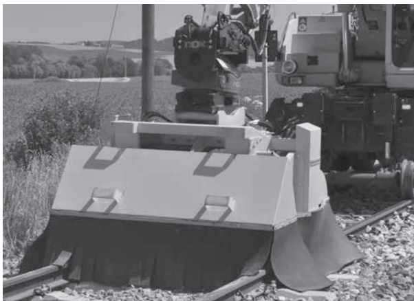
Sicheres Arbeiten auf der Trasse: Ein SKB-Ballast mit Schutzschürze aus Gummi
