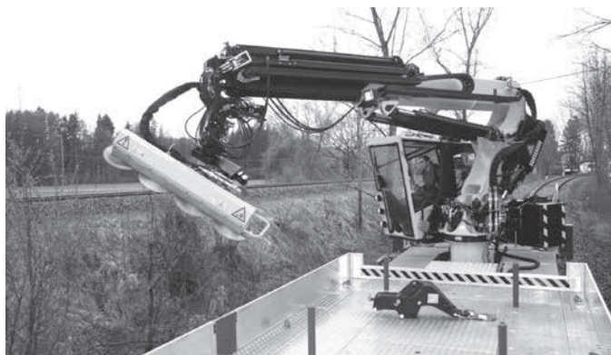
KM 931-500 an einem auf einem Wartungswagen fest montierten Kranarm (hier mit einer Astsäge)
