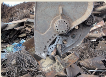
Die DRS Mobile Abbruch- und Schrottschere ist das ideale Anbaugerät für das Zerkleinern von Industrieschrott und gemischtem Schrott
