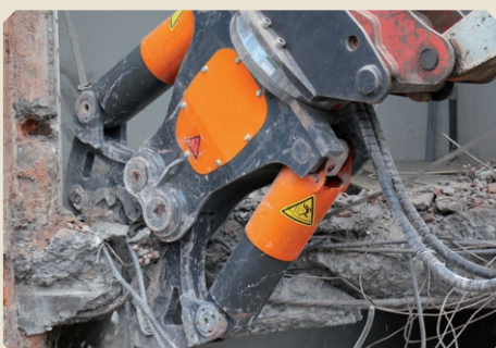
Der DRC 520 ist das optimale Anbaugerät für Abbrucharbeiten in Innenräumen. Wo es gefährlich wird, auch an ferngesteuerten Minibaggern
