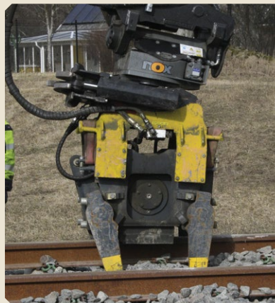
Optimal für die Verfestigung von Bahnschwellen: das RST Stopfgerät
