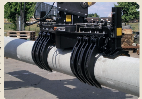
Spezielle Manipulatoren machen Vieles greifbarer. Bei Standardaufgaben machen sie sich schnell bezahlt (hier eine Sonderfertigung für variable Rohrdurchmesser).
