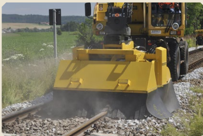
Zum Nivellieren und Verteilen von überschüssigem Schotter: SKB-Ballast
