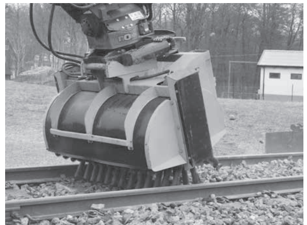
Der SKB-Ballast ohne Schutzschürze (in Schweden) macht die Funktion der Bürste deutlicher
