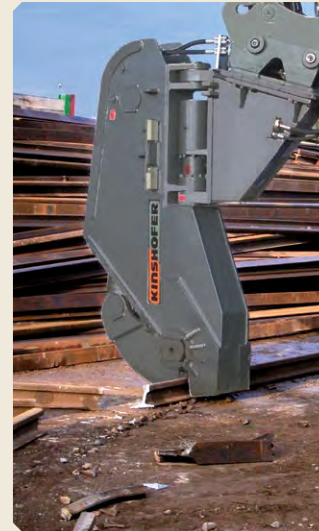
Die RC 26 R HD Mobile Schienenschere schneidet Vignol-Schienen ohne Probleme
