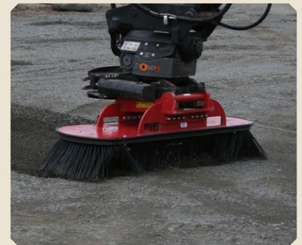
Die BST RT Kkehrbürste ist das ideale Anbaugerät um Flächen zu nivellieren und von Abfall, Wasser oder Schnee zu reinigen
