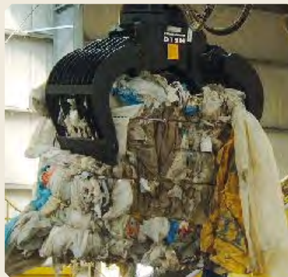
Sortieren auch gross dimensionierten Abfall: Die Abbruch- und Sortiergreifer mit Metallsiebrippen aus der D-Serie
