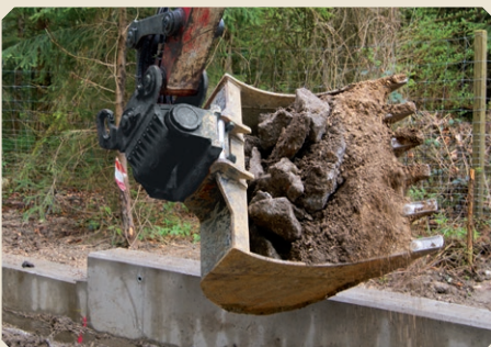
Steigert die Einsatzmöglichkeiten jedes Anbaugerätes: der RA Schwenkantrieb mit bis zu 2 x 90° Schwenkwinkel
