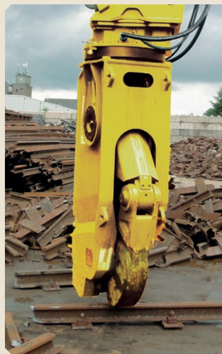
Die RC 30 mobile Schienenschere bricht Bahnschienen problemlos
