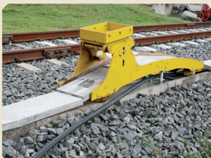
Der Schachtöffner ermöglicht das Verlegen von Schläuchen und Kabeln in bereits angelegten Schächten
