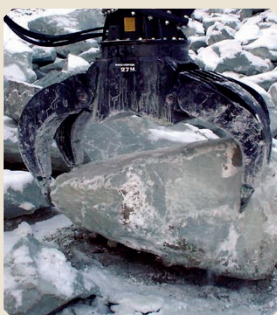
Ideal für das Laden und Positionieren von Felsbrocken: Steingreifer der R-Serie
