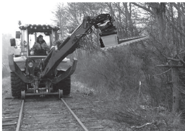
SLR 40 an einem Zwei-Wege-Traktor
