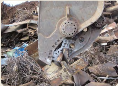
Die DRS Mobile Abbruch- und Schrottschere ist das ideale Anbaugerät für das Zerkleinern von Industrie-Metallschrott und gemischtem Schrott
