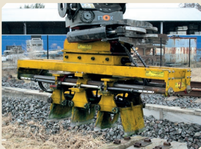
Der RUS Bahnschwellenleger positioniert mehrere Schwellen gleichzeitig
