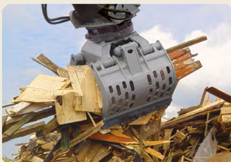
Perfekt gebaut für's Sortieren: ein Abbruch- und Sortiergreifer mit Lochrückwand aus der D-HD-Serie.
